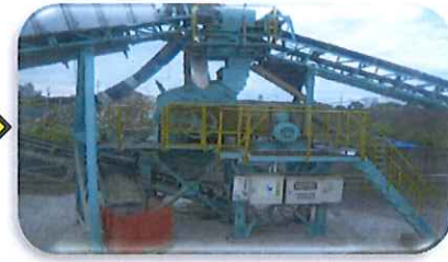
⑦第二次破碎機
